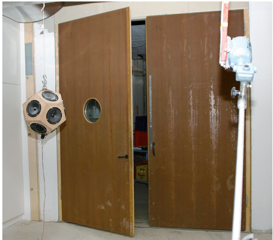
Schallprüfung einer zweiflügeligen Innentür im ift-Labor Bauakustik.
